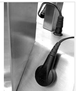
Levereras alltid med laddare för 24 Volt. Laddkontaktarna är magnetiska och kan inte placeras fel.
