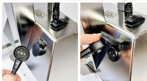
Lyftvagnen laddas med 24 volt magnetkontakt. Spolbar. IPX5.
